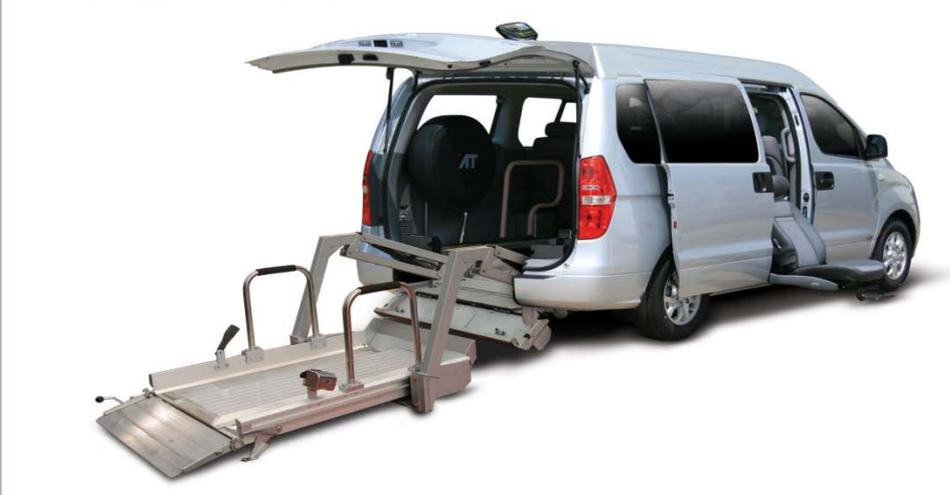
***В легковом автомобиле*** (механизм в устройстве для погрузки инвалидного кресла в багажник автомобиля)
